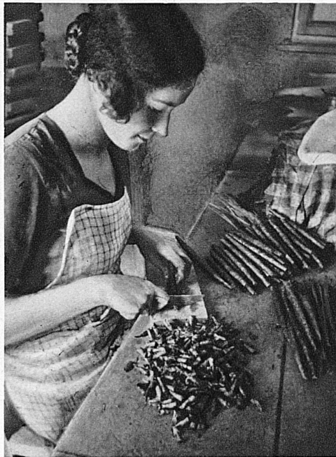
Mit flinker Hand werden die Zigarren auf die vorgeschriebene Länge geschnitten
