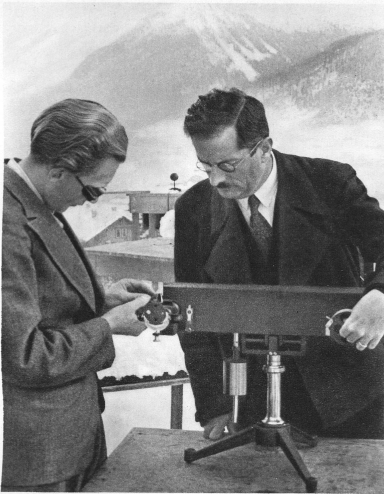
Mit dem Ultraviolett-Doppelmonochromator werden aus dem sichtbaren und unsichtbaren Spektrum der Sonnenstrahlung kleine Bereiche gesondert untersucht - Les doubles monochromator ultraviolets permettent l'examen séparé des spectres visibles et invisibles des rayons solaires sur des surfaces réduites
