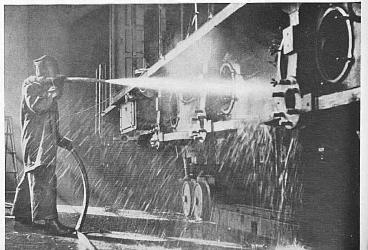
Der zusammengeschweißte Rahmen, der sich nicht mehr in kleinere Teile zerlegen läßt, wird mit einem Heißwasserstrahl von 20 Atm. Druck vom Schmutze befreit. Hierzu ist natürlich ein Abspritzraum nötig. Der «Reiniger» ist von unten bis oben durch eine Gummihülle geschützt.
