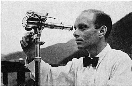
Actinomètre bimétallique pour les mensurations en série de l'intensité du rayonnement solaire, avec microscope de lecture et disque à écrans pour l'interposition d'écrans de verre coloré. Bimetallaktinometer für Serienmessungen der Sonnenstrahlungsintensität, mit Mikroskop-Ablesung und Filterscheibe zum Vorsetzen farbiger Glasfilter.
