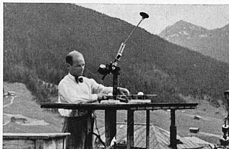
Deux solarimètres thermo-électriques pour l'enregistrement du rayonnement total du soleil et du ciel, l'un protégé de la radiation directe par un écran.
