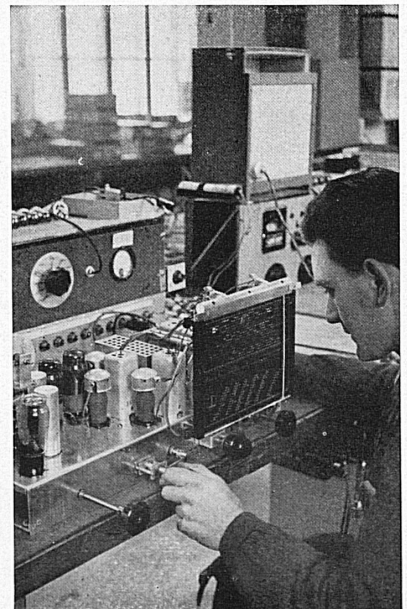
Alignement ou réglage des châssis d'appareils de radio. Regulierung der Radioapparate.
