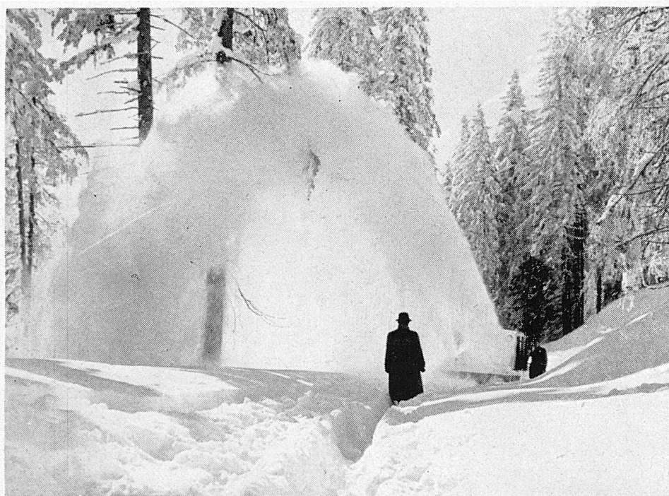
Schneefräsmaschine „Peter“ in etwa 1,5 m hoch gelagertem Schnee in voller Tätigkeit
