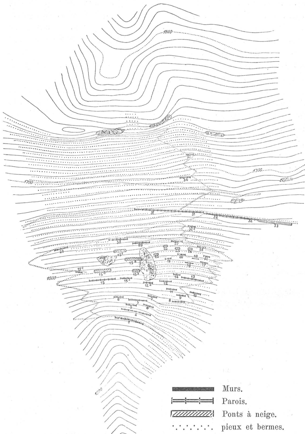
Fig. 10. Correction de l'avalanche de Calcestri. Echelle 1:1000; équidistance 5 m.
