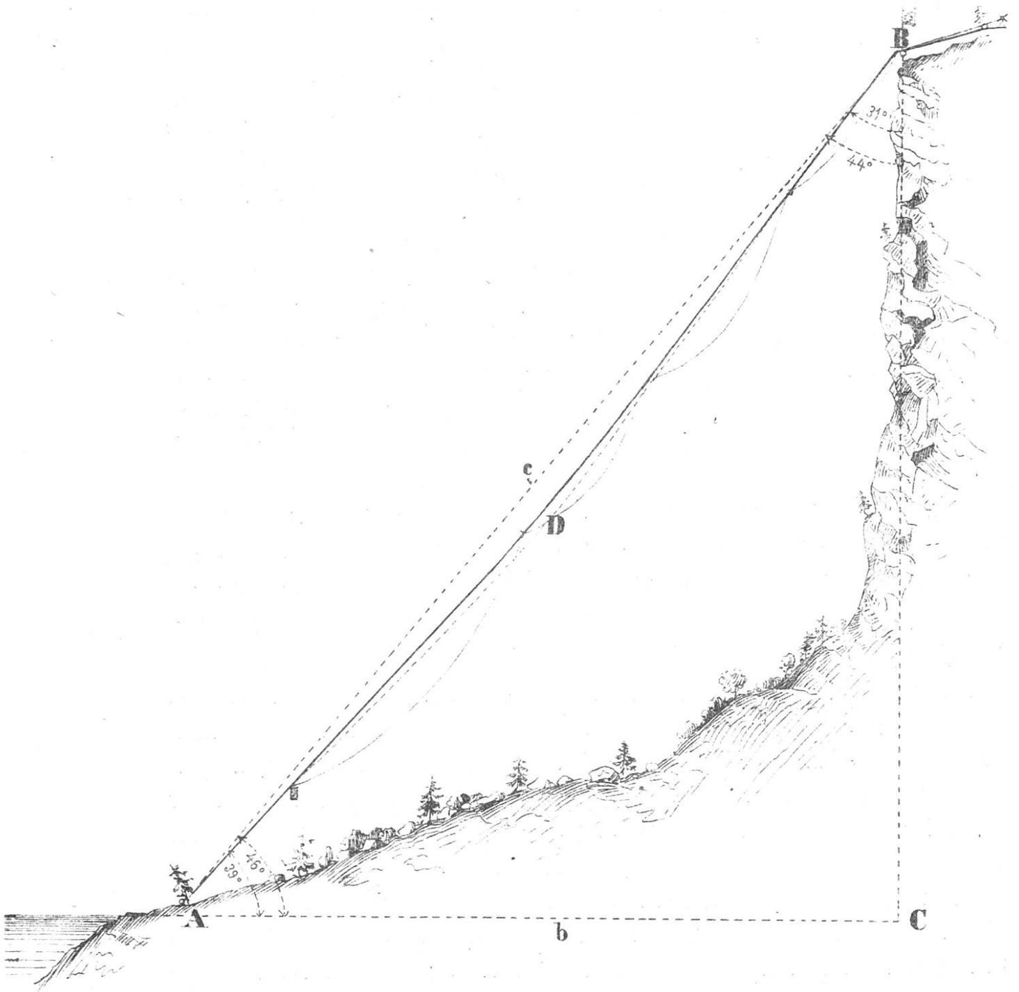
Die obere oder Absendungsstation ist über der untern oder Abnahmestation nach Messungen mit dem Barometer um circa 1647' erhaben.. Die Bisur von der untern zur oberen Station eleviert um den Winkel von 46°.
