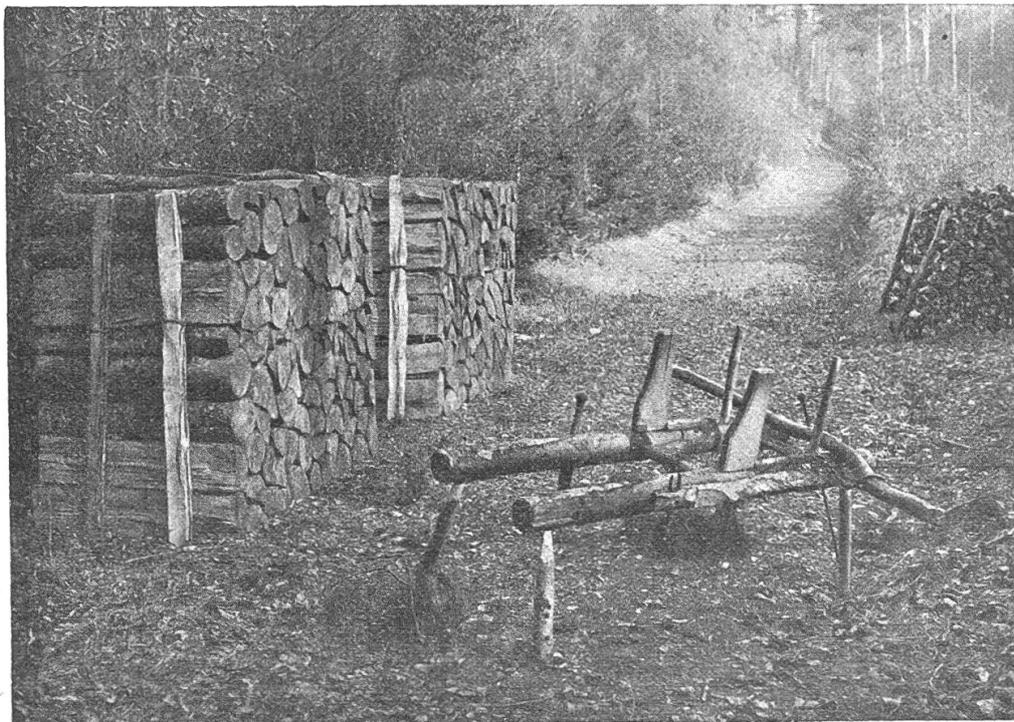
Abb. 4. Vom Holzhauer am Arbeitsplatze verfertigter Wellenbinder
