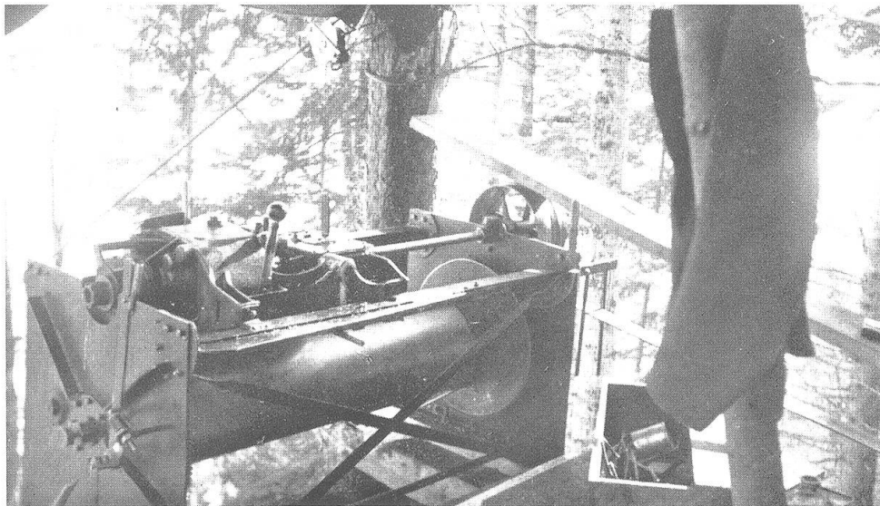
Bild 5. Seilwinde mit 300 m Förderseil; Stirnradgetriebe für 8 Geschwindigkeiten; 2 voneinander unabhängige Bremsen. Mit dieser Winde wird auch das Trageil in Richtung gezogen und gespannt.
