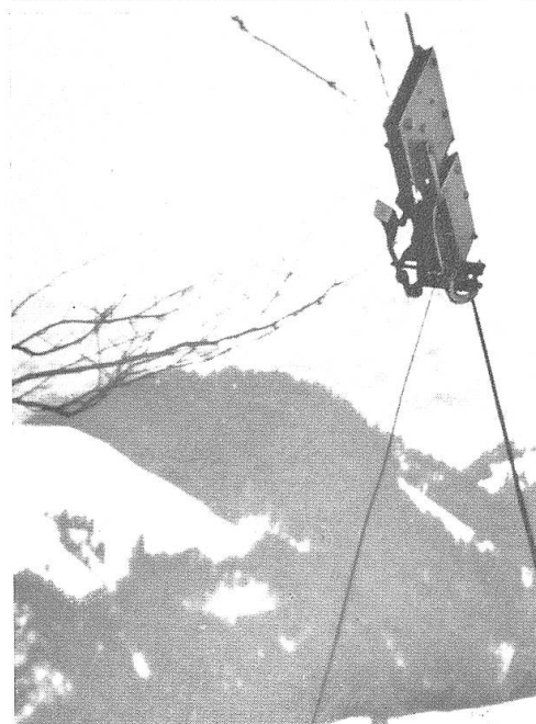
Bild 7. Der Laufwagen ist an den Stellwagen angefahren und gekuppelt worden.
