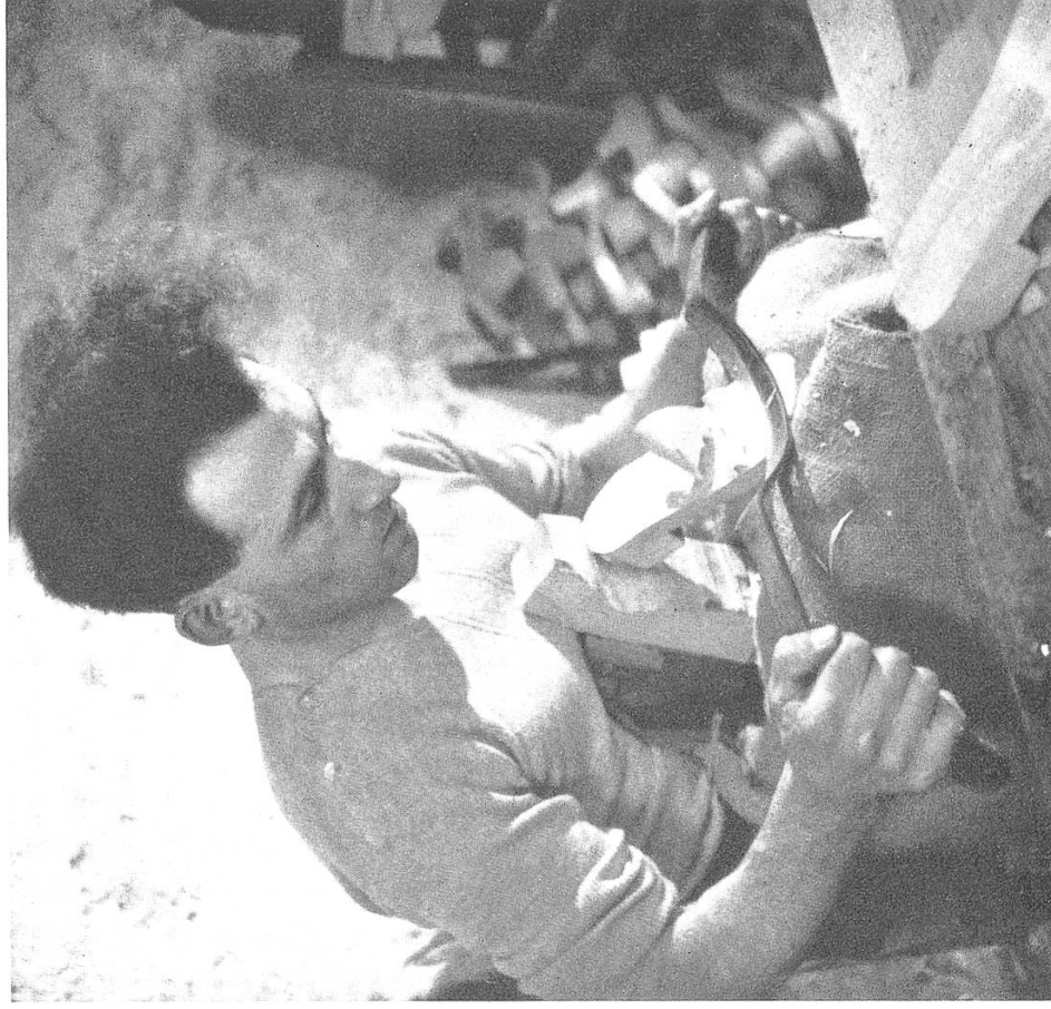
Mit Ziehmessern von verschiedener Form werden Sohle und Absatz säuberlich zurechtgeschnitten.
