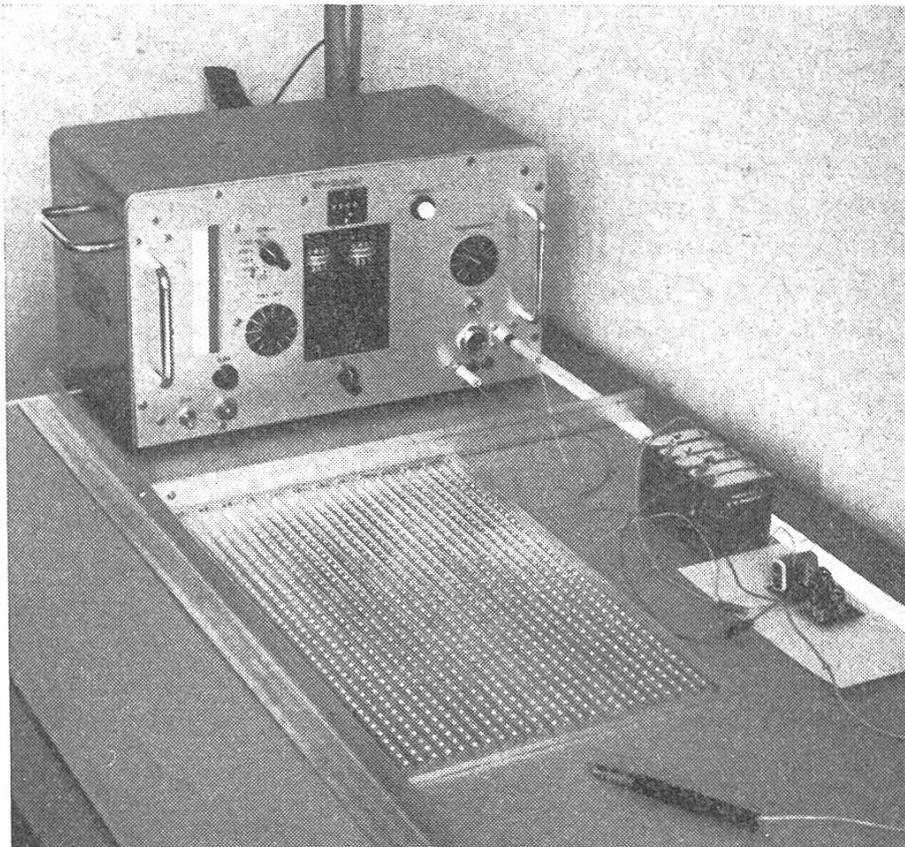
*Die Meßeinrichtung:* Links auf dem Leuchttisch der elektronische Zähler, rechts ein Batteriesatz und der Schmitt-Trigger. In der Mitte liegt die Lochplatte, die durch die beiden Metallschienen in die richtige Lage gebracht werden kann. Der Photowiderstand in der Hülse im Vordergrund ist mit einem Kabel über den Schmitt-Trigger mit dem Zähler verbunden.
