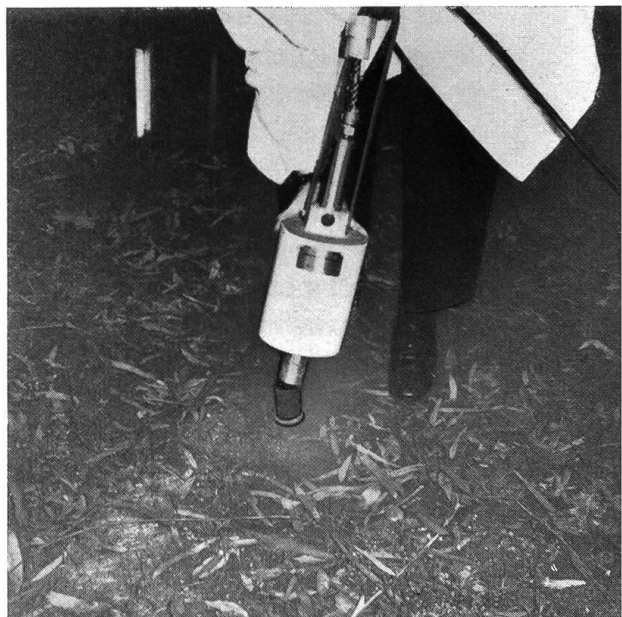
4. Misure dell'umidità nel terreno con sonda a neutroni.
