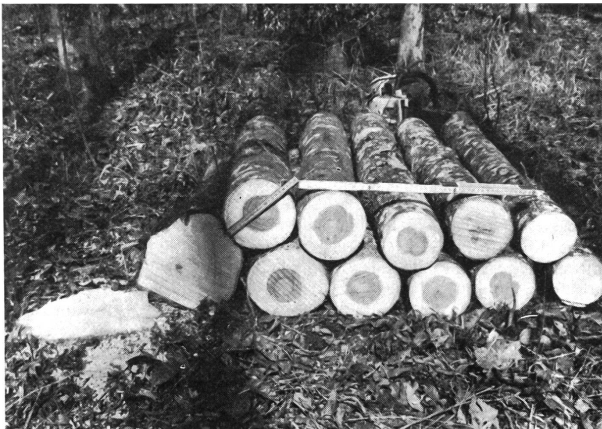
Abbildung 6. Dieselbe Esche gefällt: Holz bis 1 m ab Boden weiss, dann 8 m Braunkernbildung, weiter oben wieder weiss.
