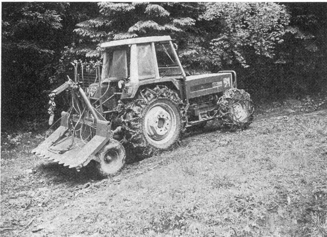
Abbildung 5. Der Steyr-Rückewagen lässt sich ohne viel Zeitverlust an der Dreipunkthydraulik von Ackerschleppern befestigen und wird in land-/forstwirtschaftlichen Mischbetrieben zunehmend verwendet. (FV Stift St. Paul, Kärnten)
