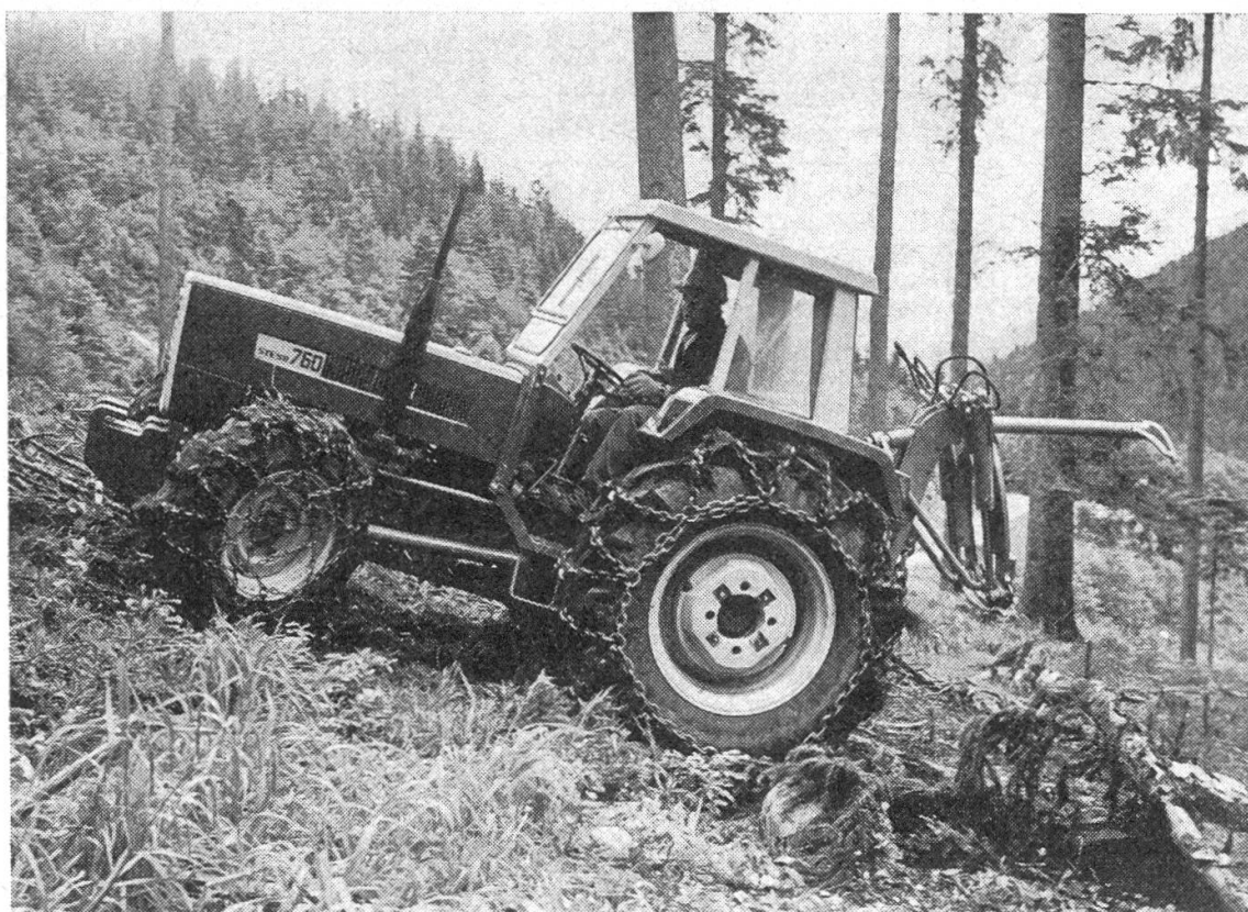
Abbildung 4. Mit Allradantrieb und Ringstollenketten überwinden auch traditionelle Schlepper bedeutende Steigungen. Die Kuxmann-Rückezange befähigt sie ausserdem zur Rückung von Langschäften. (ÖBF Ort, Oberösterreich)
