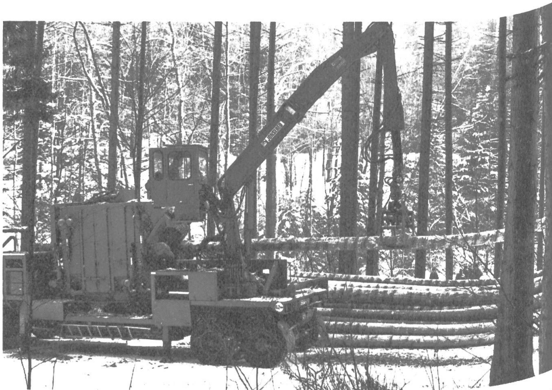
Abbildung 2. Maschinelle Entrindung von Stammholz auf der Waldstrasse. Es ist nur der Anhänger des gesamten Entrindungszuges mit dem eigentlichen Entrindungsaggregat zu sehen. Das Zugfahrzeug trägt den zweiten Kran zur Aufnahme der unentrindeten Stämme. (Foto: Bildarchiv BAF)
