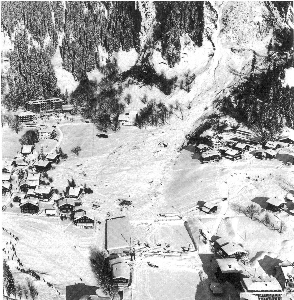
Abbildung 1. Lawinenniedergang Wengen vom 3. Februar 1978. Dank angepasster Bauzonplanung waren nur relativ geringe Sachschäden zu verzeichnen (Aufnahme: Militärflugdienst Dübendorf).
