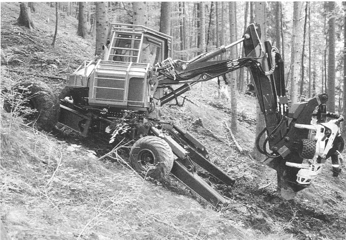
Abbildung 3. Schreitbagger als Trägerplattform für Vollerntertechnik (Foto WSL).
