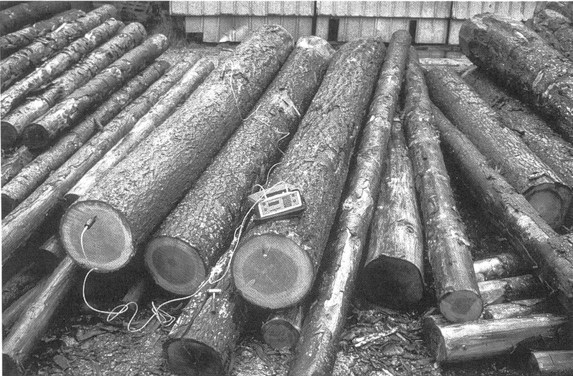
Figure 6. Appareil Sylvatest®, pour le classement mécanique des bois de construction, basé sur le principe des ultrasons basse fréquence, avec ses sondes émettrices et réceptrices, et le capteur de correction de l'effet de l'hygroscopie.
