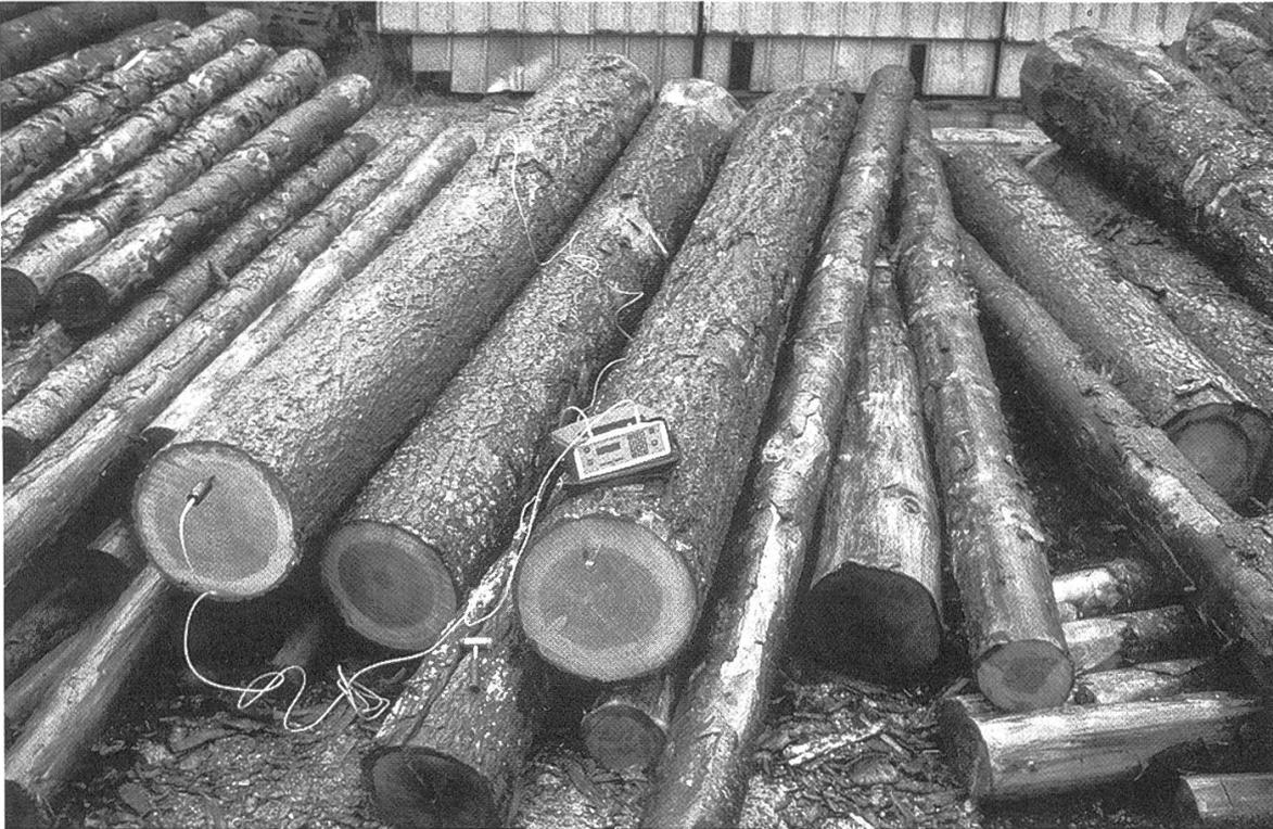
Figure 6. Appareil Sylvatest®, pour le classement mécanique des bois de construction, basé sur le principe des ultrasons basse fréquence, avec ses sondes émettrices et réceptrices, et le capteur de correction de l'effet de l'hygroscopie.
