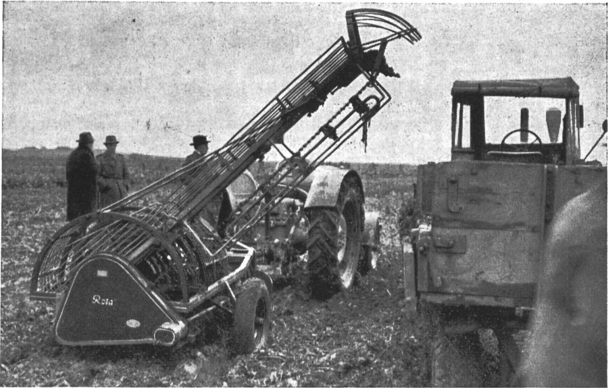
Fig. 1: Arracheuse à betteraves à 2 lignes «Rota» avec élévateur.
