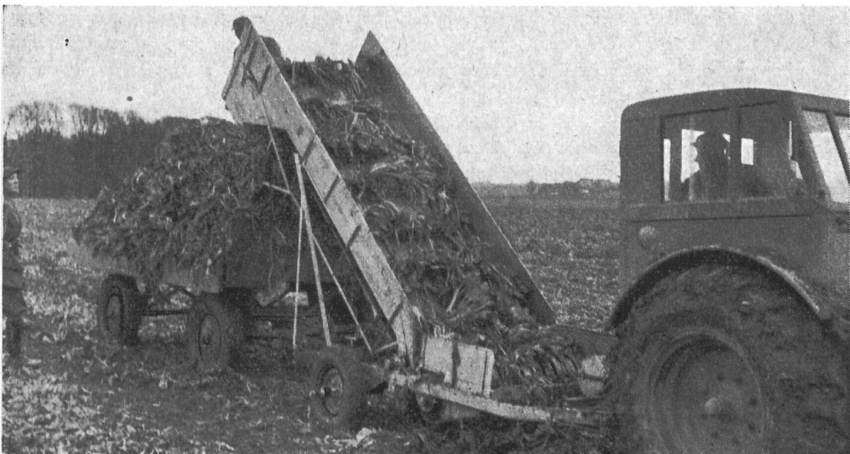
Fig. 5: Chargeuse à feuilles «Spragelse».
