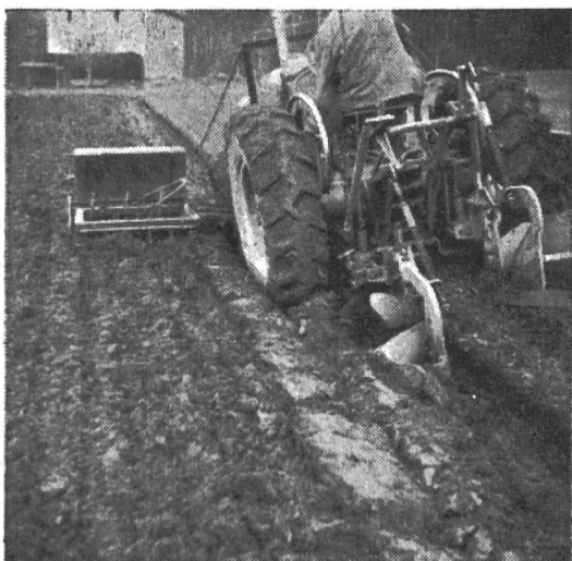
Labourage et hersage en une seule opération.
