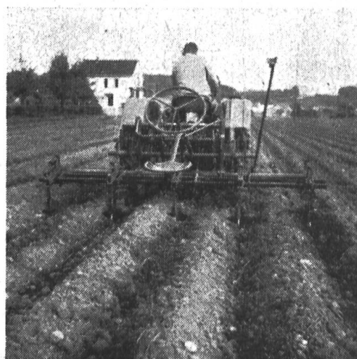
Fig. 1b: Recouvrement et buttage au moyen de la machine universelle portée à 4 lignes.
