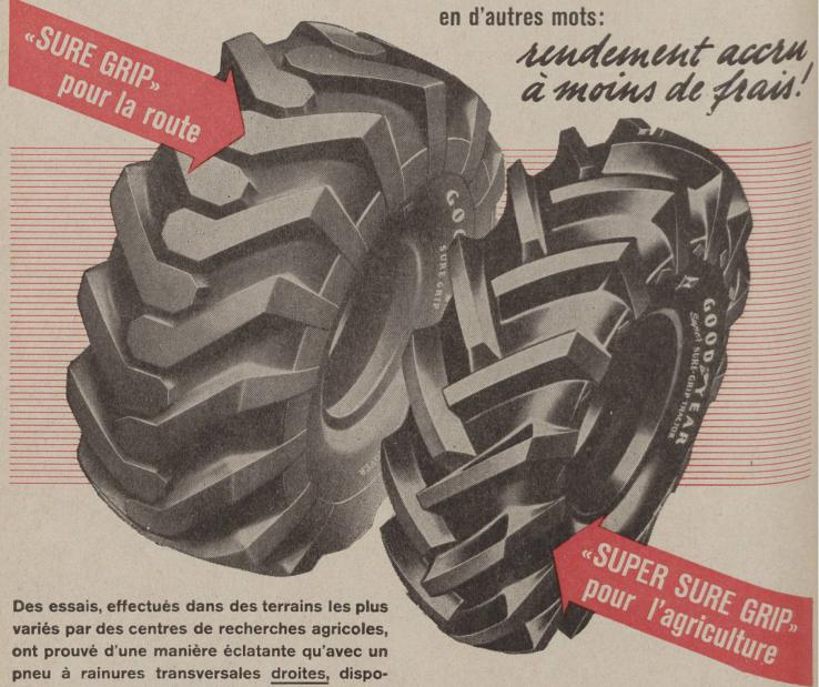
sées en forme de cône et interrompues au milieu, on obtient - et de loin - le meilleur pouvoir de traction, car il se nettoie de lui-même.
