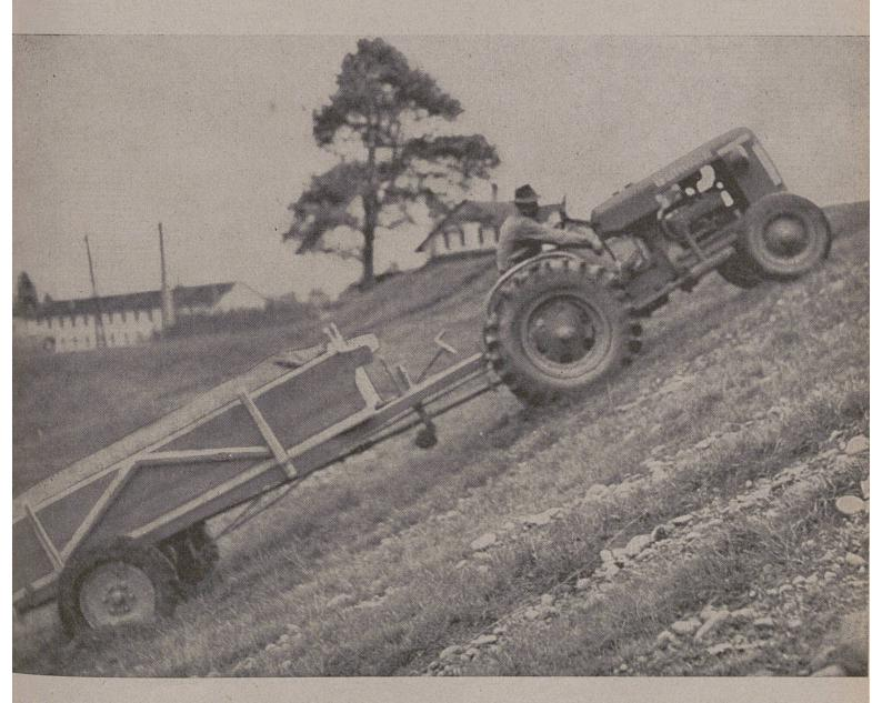
La remorque «Stura» (Uesslingen TG) avec essieu moteur «Kessler» est la grande nouveauté qui contribue à la motorisation de l'agriculture. Un tracteur léger avec une remorque entraînée par la prise de mouvement est d'un prix plus avantageux et d'un rendement supérieur.
