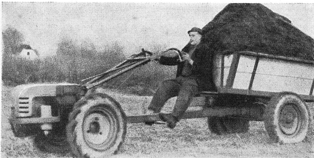
Fig. 3 Tracteur à 1 essieu avec remorque à essieu propulseur.
