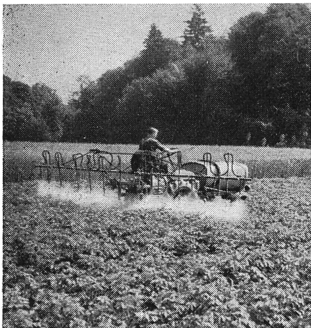
Fig. 14: Pulvérisateur automoteur avec barre de traitement.
