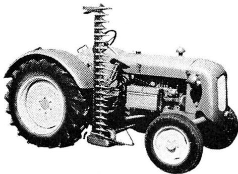
Le nouveau tracteur **Vogel-Diesel** va de succès en succès, et il le mérite. Car il n'y en a pas de plus robuste. Moteur Ford Diesel, 18/45 ch, 1900 kg. Braquage facile et court. Voie réglable. Bloquage différentiel, freins tambours formidables. lère vitesse lente, pour ensileur ou moissonneuse - batteuse. Possibilité de monter tous les accessoires. Demander offre et démonstration.
