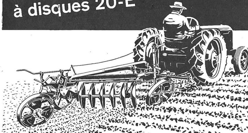
...un modèle de fonctionnement aisé, pour tracteur et attelage. Elle déchaume, herse et pulvérise simultanément.
