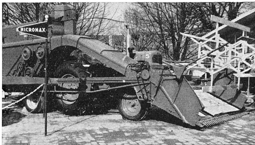
2 Moissonneuse-batteuse Dhotel avec tracteur «incorporé».
