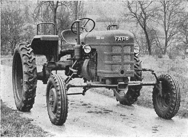
Fig. 3: Tracteur Fahr D 130 H, à moteur Diesel, montré avec l'écartement de voie maximum (1924 mm).
