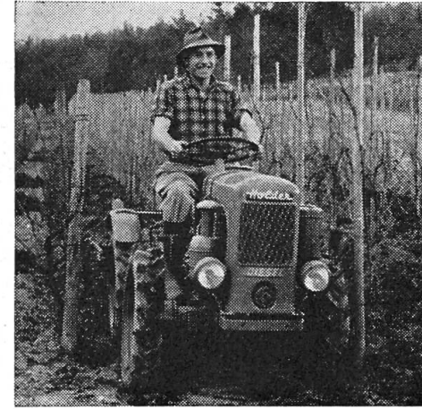
Fig. 6: Le Cultitrac Holder — machine prévue pour la viticulture, l'horticulture et les plantations de houblon.
