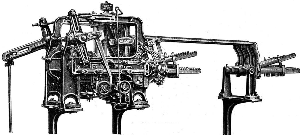
Die ein-cylindrige, doppelhebende Schaffmaschine von Schelling & Cie. wurde in jüngster Zeit neu konstruirt und mit verschiedenen praktischen Neuerungen resp. Verbesserungen versehen. Alle Theile, die am meisten beansprucht werden und deshalb dem Defektwerden besonders ausgesetzt sind, sind, ohne dass die Maschine selbst vergrößert wurde, so konstruirt, dass sie einer zwei- bis dreifachen Beanspruchung unter-
