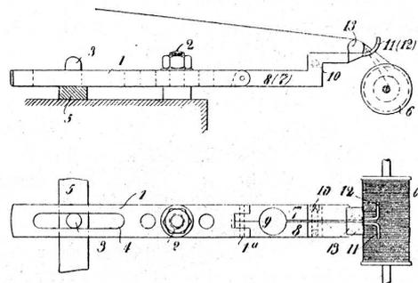
versehenen Schraube 10 kann der Schlitz zwischen den Stäben 7 und 8 der Dicke des Garnes entsprechend verstellt werden. Mit 11 und 12 sind die leitenden Fühlerdrähte bezeichnet und 13 ist eine stabförmige Erhöhung, über die der Faden, der auf der Spule 6 aufgewunden wird, gleitet.
