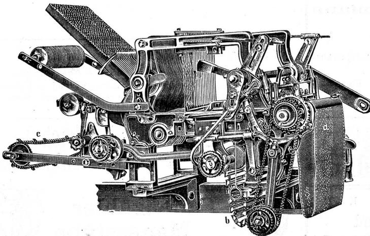
Schaftmaschine mit Papierdessin-Cylinder und Holzarten-Cylinder, automatische Umschaltung beider Cylinder, zweckmässig für **Servietten- und Foulardfabrikation** etc
