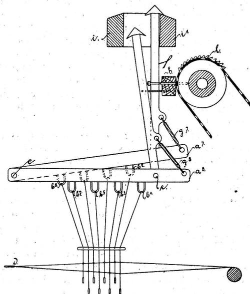
In der Abbildung sind diese Hebel mit a a<sup>1</sup> usw. bezeichnet, b b<sup>1</sup> etc. sind Schlaufen, an denen die Harnischschnüre hängen. Die Hebel a a<sup>1</sup> sind bei c drehbar und bei e stehen sie gelenkig mit den Platinen f in Verbindung, die durch Federn g gegen die Nadeln h gedrängt werden. Der Drehpunkt c der Hebel a liegt ungefähr oberhalb der Stelle, an der das Riet d den Schuss an die Ware anpresst. Die Maschine ist mit zwei Messern i i<sup>1</sup> versehen, die nach
