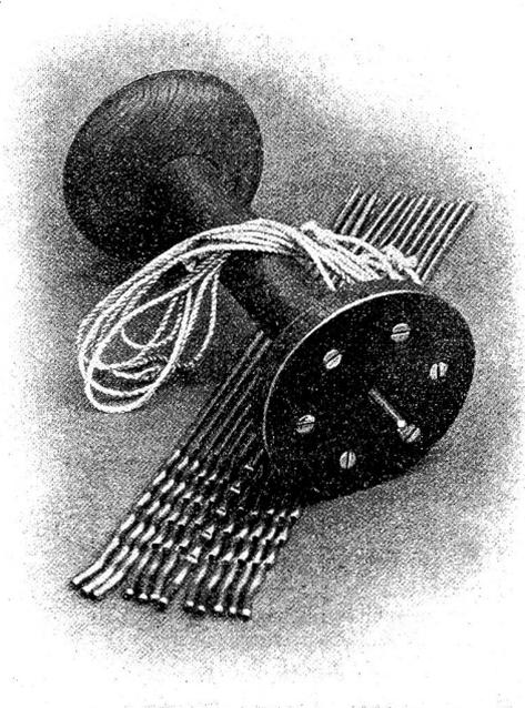
„Elastic“ demontiert. Durch das leichte Demontieren u. Montieren des Haspels kann man durch Auswechseln der Seitenstäbchen rasch einen Haspel für grössere oder kleinere Strangenweiten herstellen. Ferner kann der Haspel in demontiertem Zustande versandt werden.
