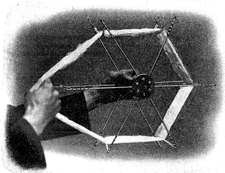
„Elastic“ beim Auflegen der Strange. Infolge der grossen Elasticität der Seitenstäbchen ist es möglich, eine neue Strange aufzulegen, ohne die Verbindungsschnürchen in den Auskerbungen nach einwärts verschieben zu müssen.
