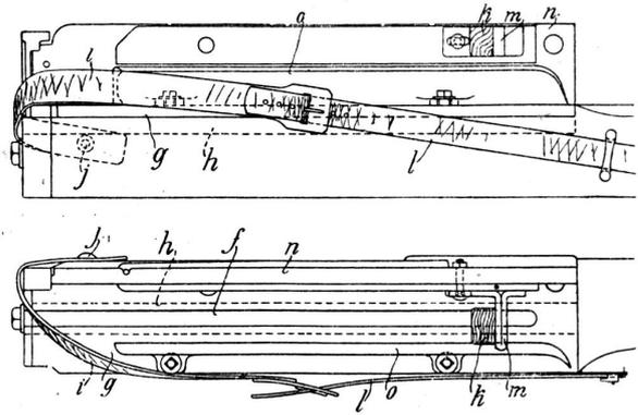
Am inneren Schützenkastenende wird der Treiber selbst überhaupt nicht aufgefangen, sondern durch den Schlagriemen in seiner Bewegung begrenzt, für den ein feststehender Anschlag *k* oberhalb der Treiberbahn angeordnet ist, so dass dieser Anschlag auch dem ein- und austretenden Schützen nicht mehr im Wege ist.
