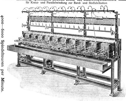
Neuheit! Zwillings-Kreuzspulmaschine "Productive", Modell C, mit pat Differenzialverschiebung jeder einzelnen Spindel für einfache Spulung ab Kops und Rollspulen.
