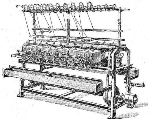
**Pat. Kreuzschußspulmaschine Produktiv G K**
