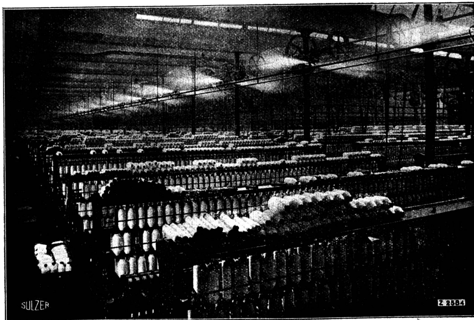
Abbildung 6: Druckluftbefeuchtungsanlage System Sulzer in einem Ringspinnsaal.
