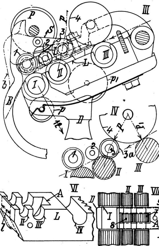
Die, eine neuartige Cylinderbelastung für Klemmwalze 4 zeigende Fig. II weist einen am Gewichtshaken B angelenkten Sattel S federbelastender Art auf, wodurch die erforderlich richtige Druckrichtung P unabhängig derselben nach Linie 12 bewirkt werden kann. Desselben Systemes ist die Cylinderbelastung B und S für ein mit Vorverzug ausgestattetes Doppelroller-Streckwerk nach Fig. III, das auch mit Laufleder 1 ausführbar ist.
