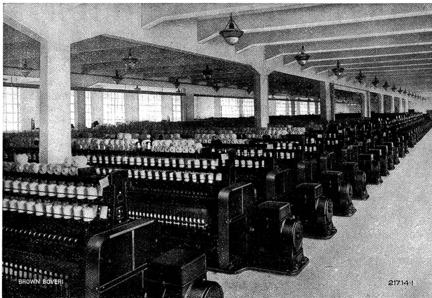
Abb. 1. Regulierbare Antriebe in einer Baumwollzwirnerei.
