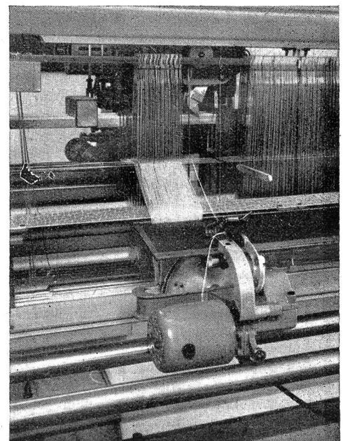
„ZELLWEGER“. Die Kombination dieser beiden Maschinen gestattet den Einzug der Kette in Lamellen, Geschirr und Blatt durch nur eine Person in einem einzigen Arbeitsgang. Das Bild läßt den von der Arbeiterin durch Litze und Lamelle zur Wegnahme des von der „Turicum“ bereitgehaltenen Fadens gesteckten Einziehhaken (Reihhaken) erkennen und zeigt die neue Webeblatteinziehmaschine „Zellweger“, wie sie ein vorgängig in Litzen und Lamellen eingezogenes Fadenpaar ins Blatt sticht.
