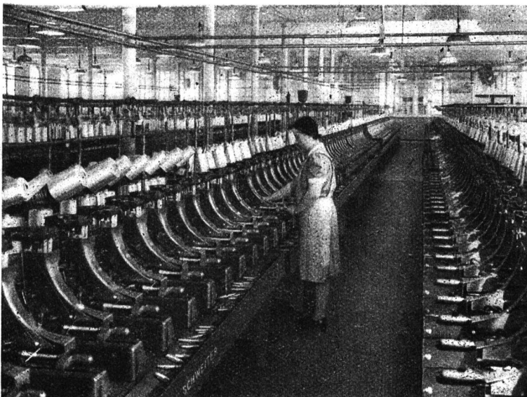
Der Schweiter Schuß-Spulautomat Typ MS in der Weberei The Schweiter Automatic Pirn Winder Type MS in weaving mills
