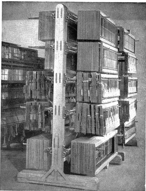
Teilansicht einer modern eingerichteten Geschirrkammer mit der GROB-Aufhängevorrichtung
