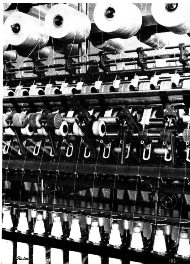
Rieter Cutdrafil-Ringspinnmaschine, Streckwerk
