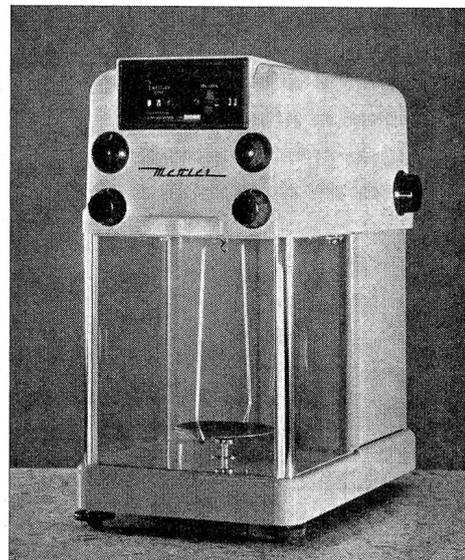
Mettler Analysenwaage Typ H6T dig.
