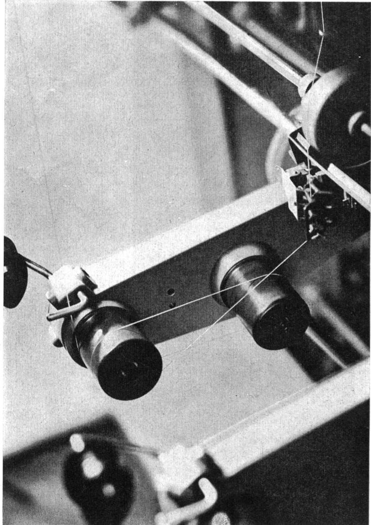
Von den Vorlagekörpern herrührende Spannungsschwankungen werden vom Fadenlieferwerk aufgefangen und gelangen nicht zum Spulprodukt
