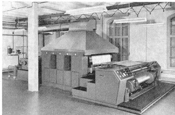
Abb. 8 Gesamtansicht einer Schlichtmaschine Modell SMA zur Verarbeitung von Ketten aus Endlosmaterialien nach dem Schärwalzensystem
