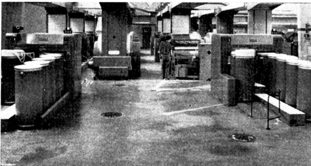
Im modern eingerichteten Spinnereisektor beeindruckte die moderne Karderie, ausgerüstet mit Rieter Hochleistungskarden C 1/1 und wickelloser Kardenspeisung System «Aerofeed»®
