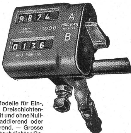
Diverse Modelle für Ein-, Zwei- und Dreischichtenbetrieb, mit und ohne Nullstellung, addierend oder subtrahierend. — Grosse Zahlen. Staubdichter Gehäuseverschluss. — Solide Bauart. Grosse Präzision.
