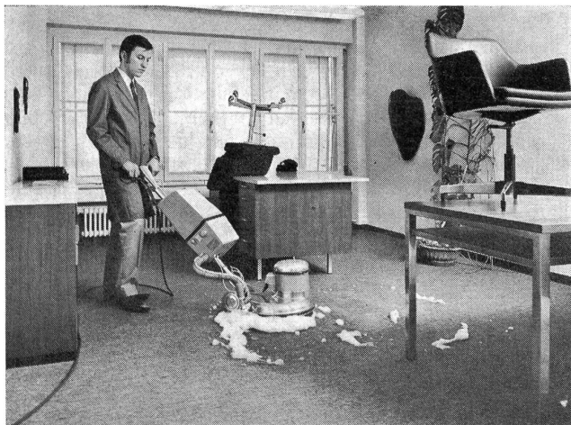
Das Schaumaggregat mit elektronisch gesteuerter Schaumfeuchtigkeit — der Shampomat von Servo-Wetrok — in Verbindung mit einer Einscheiben-Bodenreinigungsmaschine Typ 215.
