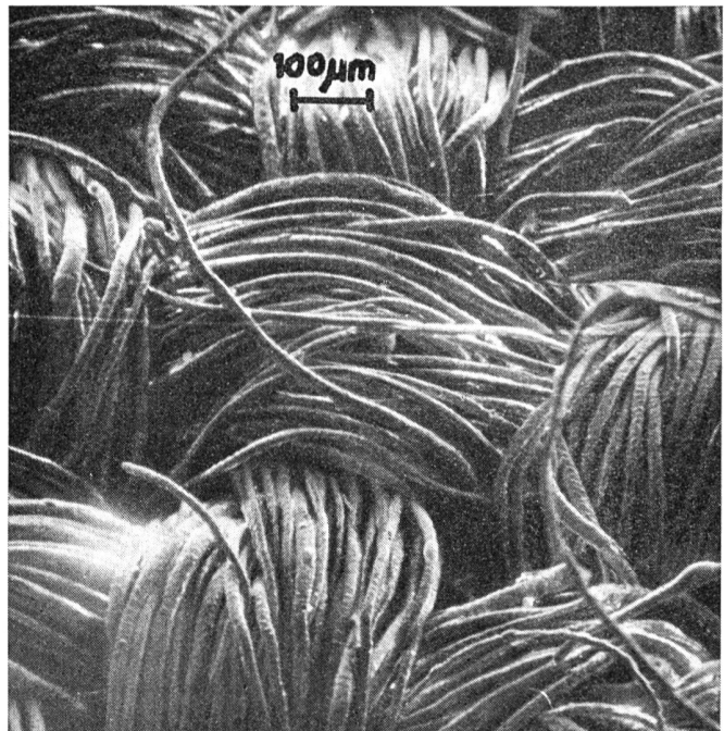
Abb. 13 Wollgewebe mit Filzfrei-ausrüstung (Sekundärelektronen-Bild)
